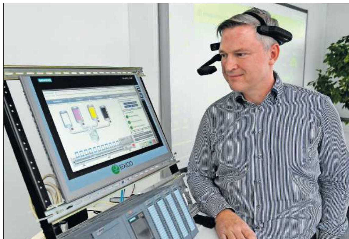
Mit Sprachbefehlen lässt sich eine Produktionsanlage steuern: Andreas Saddey von Exco PCC nutzt in der Demonstration dazu einen Minirechner mit speziellem Zubehör, der auf dem Kopf getragen wird. FOTO: BOLTE
