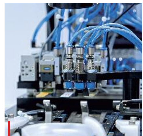
Ein Prüfplatz zum automatisierten Testen eines medizinischen Kleingerätes, hier bspw. beim Tastentest.
