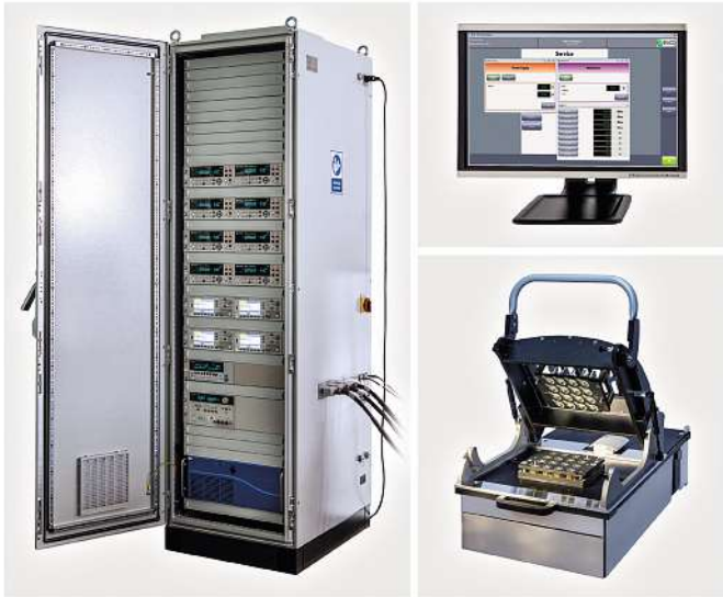
Bild 4: Drei Hauptbestandteile sind die Basis des Prüfstands: der Nadeladapter zur Kontaktierung der Prüflinge, ein Schaltschrank mit Mess-equipment und ein Industrie-PC mit Testsoftware (einschließlich Monitor zur Visualisierung).
